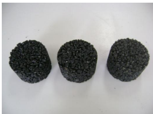
Figura 6 – Cps de polímero SBS antes da realização do Ensaio Cántabro
