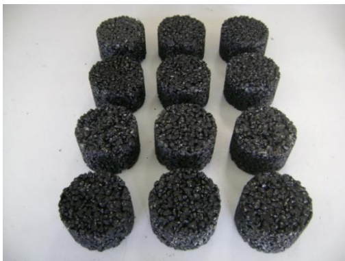
Figura 8 – Cps de polímero SBS depois da realização do Ensaio Cántabro
