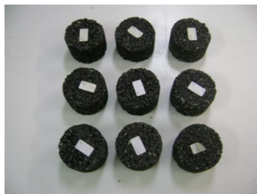
Figura 7 – Cps de asfalto borracha antes da realização do Ensaio Cántabro
