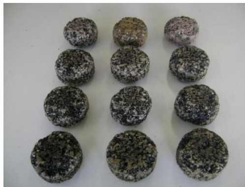
Figura 9 – Cps de asfalto borracha depois da realização do Ensaio Cántabro
